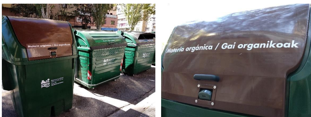
Figura 1. Contenedores para la recogida selectiva de la materia orgánica que incorporan un mecanismo de cierre mediante cerradura mecánica en Pamplona. Fuente: Institut Cerdà, 2018.
