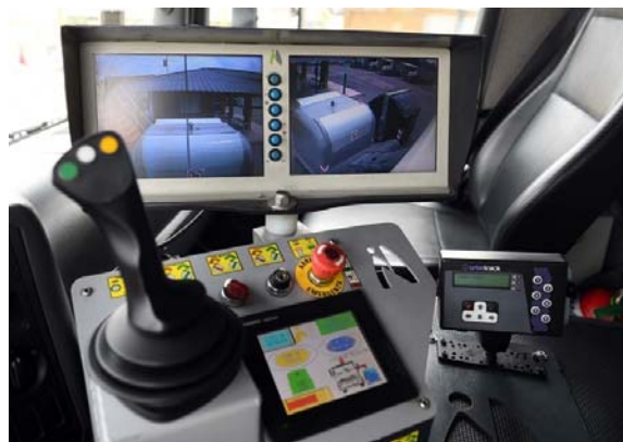
Figura 1. Sistema a bordo de visualización y control remoto de vehículo recolector de residuos municipales. Fuente: EYS Municipales, 2017.
