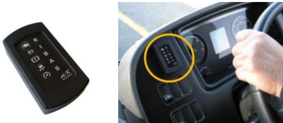
Figura 1. Dispositivo para guiar el conductor hacia una conducción eficiente. Los símbolos indican: [R], exceso de revoluciones; [I], ralentí excesivo; [B], frenada brusca; [A], aceleración brusca; y, [S], velocidad excesiva. Fuente: Chip2Chip, 2017.
