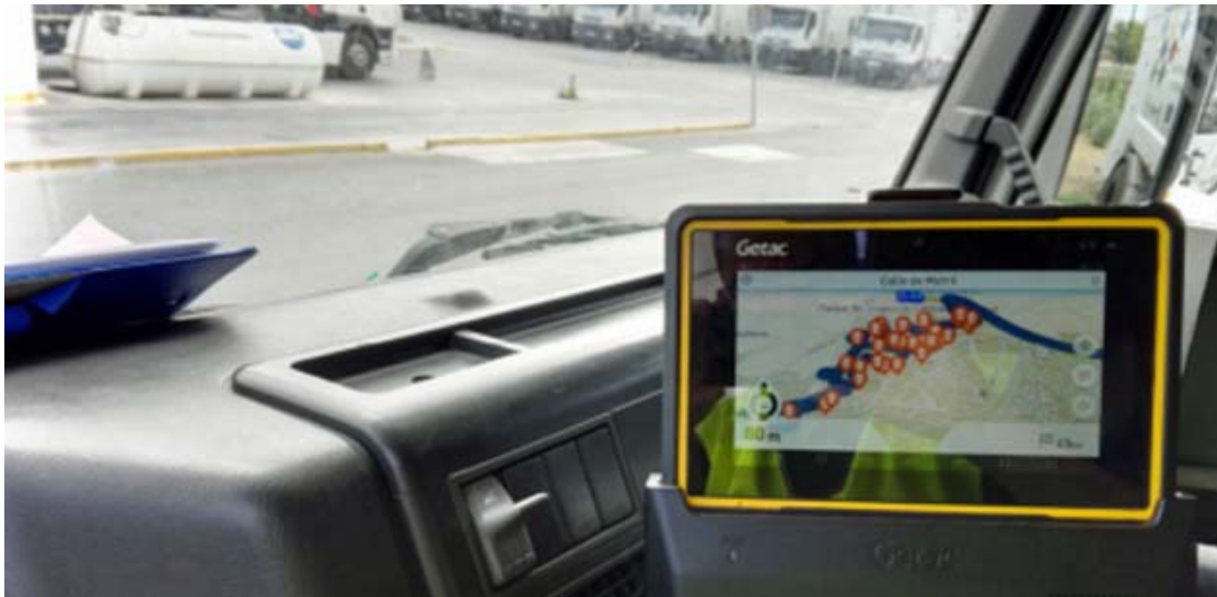
Figura 2. Imagen del navegador a bordo con el sistema de optimización de rutas. Fuente: eSMARTCITY, 2018.
