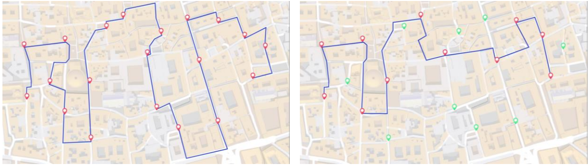
Figura 1. Optimización de las rutas de recogida de residuos gracias a la utilización de sensores volumétricos: ruta predefinida (izquierda); y, ruta optimizada en base a la información proporcionada por los sensores volumétricos instalados en los contenedores (derecha). Fuente: Evreka, 2018.
