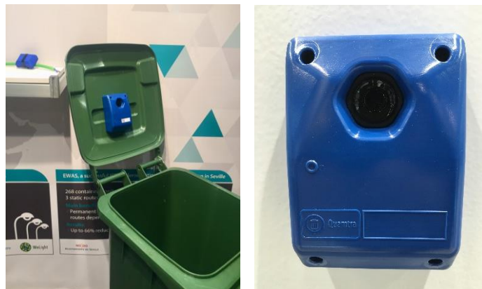
Figura 2. Sensores volumétricos utilizados en Sevilla. Fuente: Wellness Telecom e Institut Cerdà, 2018.
