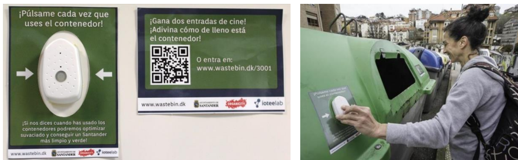
Figura 1. Pulsador y código QR utilizados en el marco del proyecto OrganCity 2 en Santander, con el objetivo de controlar el nivel de llenado de los contenedores de vidrio. Fuente: eSMARTCITY.es y El Diario Montañés, 2018.
