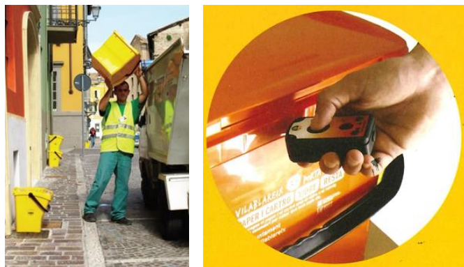
Figura 4. Sistema de lectura a través de los elementos a bordo del vehículo de recogida (izquierda); y, sistema de lectura a través de un lector manual (derecha). Fuente: ID Waste, 2017.
