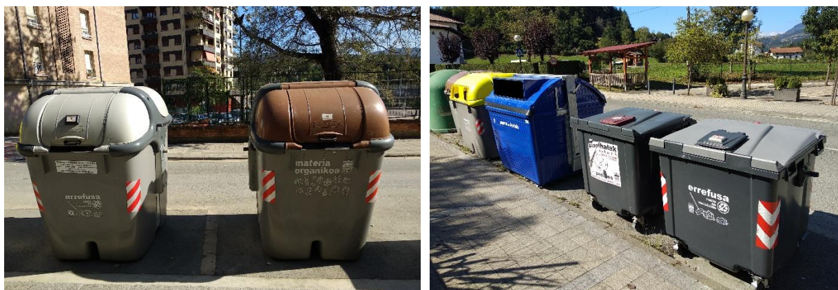
Figura 1. Contenedores con cerradura de apertura mediante tarjeta Mifare en la Mancomunidad Sasieta: contenedores de carga lateral en Beasain (izquierda); y, contenedores de carga posterior en Ormaiztegi (derecha). Fuente: Institut Cerdà, 2018.
