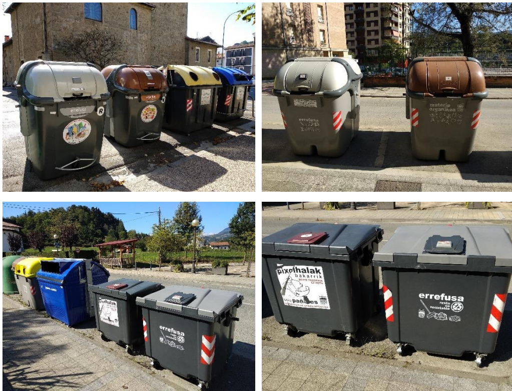
Figura 3. Contenedores que incorporan un sistema de apertura mediante tarjeta magnética: contenedores de carga lateral en Zarautz, País Vasco (superior izquierda) y Beasain, País Vasco (superior derecha); y, de carga trasera en Ormaiztegui, País Vasco (inferior). Fuente: Institut Cerdà, 2018.
