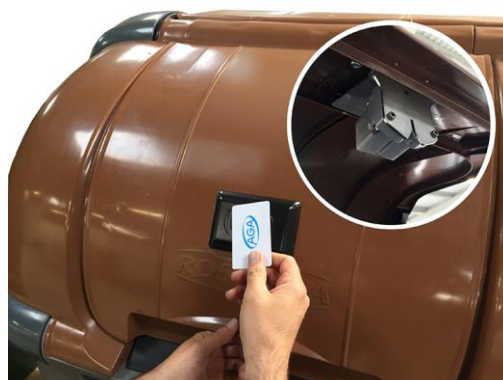
Figura 1. Sistema de cierre de los contenedores: cierre electrónico. Fuente: AGA-Dorlet, 2017.
